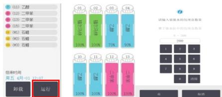
设置结束时间：**立即开始**-脱水即刻开始，注意观察结束时间；**编辑结束时间**-延迟开始，输入的时间即为设定的时间。再点击“启动”开始运行程序。
