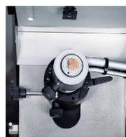
样本托放置在样本头上，拧紧样本头固定螺丝。
