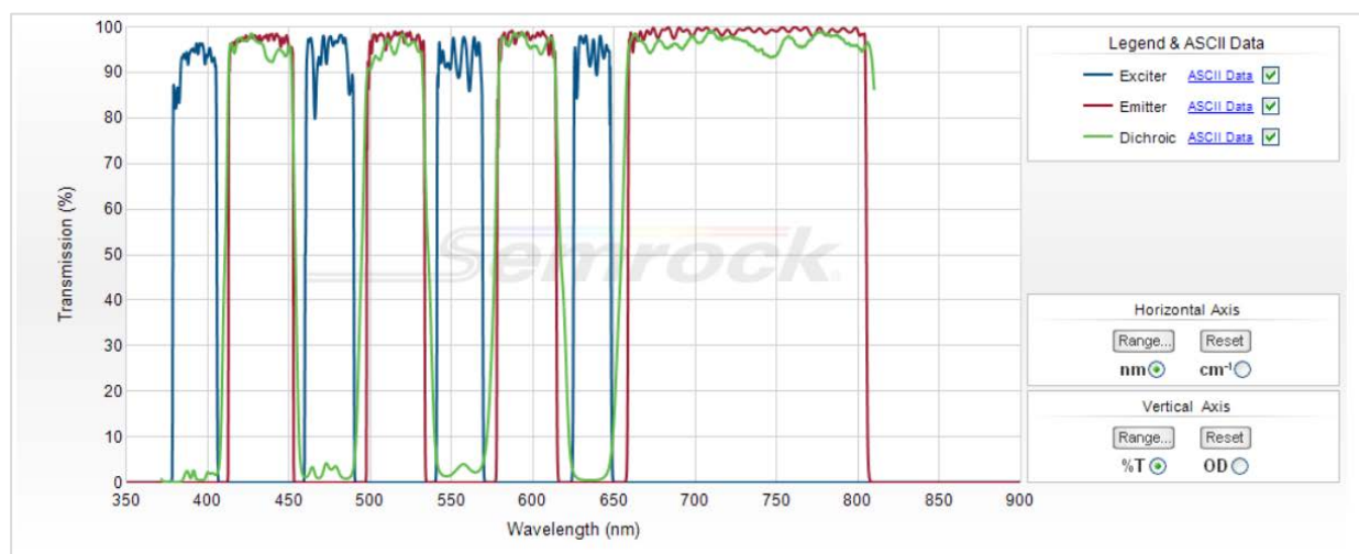
图 16: 全波段滤光片组的透射曲线，内置 T 图像（图片来源：Semrock 网站 www.semrock.com ）
