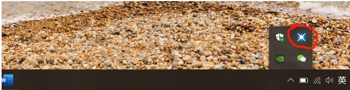
2) 正常情况下，打开电脑待 Tecan 服务程序运行，打开酶标仪后将在 30s 内正常连接，超时指示灯仍未变成玫红色，说明连接失败。处理方法：
