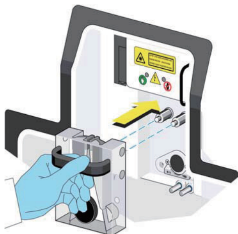
图 9.4 更换电极板组件
