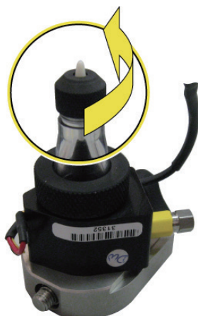
图 10.4 旋松喷嘴头扣环
