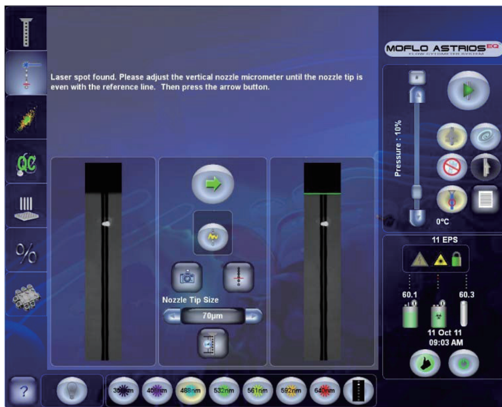
图 6.8 激光光斑测定确认
