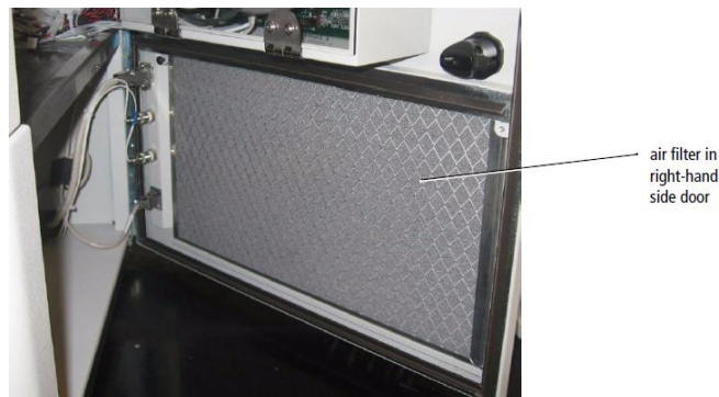
图 6-15 更换空气过滤网
